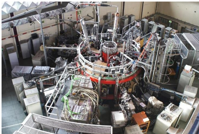
Figura 14. ICTS Laboratorio Nacional de Fusión. Radicado en Madrid, está dedicado a la investigación y desarrollo de tecnologías y materiales para construir y operar los reactores de fusión del futuro. Su principal instalación es el TJ-II, un dispositivo de confinamiento magnético de tipo stellarator; cuenta además con instrumentación para la caracterización y modificación por radiación de materiales. Fuente: Ministerio de Ciencia e Innovación.
