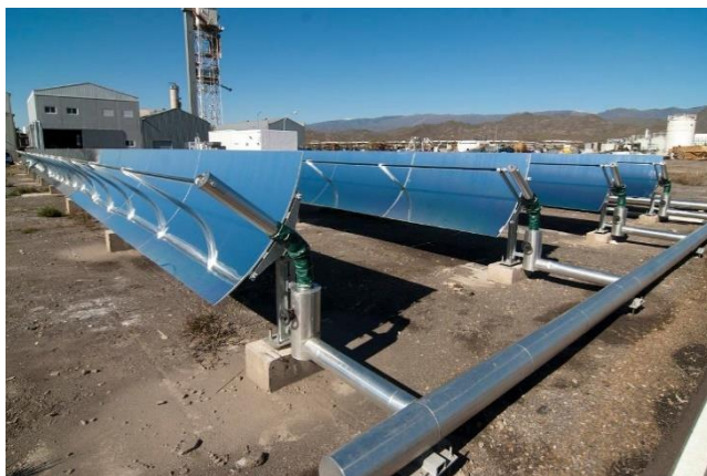
Figura 15. ICTS Plataforma Solar de Almería, en Andalucía. Está dedicada a la experimentación de sistemas de energía solar. Dispone de grandes instalaciones de ensayo, como sistemas de receptor central, campos de captadores de cilindros parabólicos, hornos solares y plantas piloto de desalación, fotoquímica y fotocatalisis. Fuente: Ministerio de Ciencia e Innovación.
