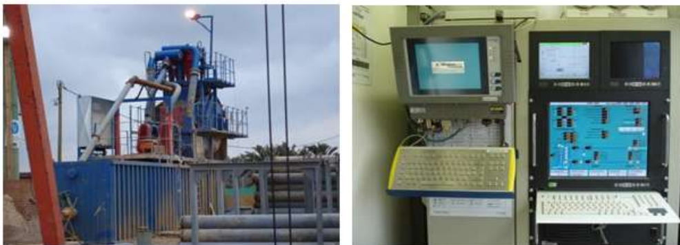
Estación separadora Schauenburg MAB400 Ordenador de control del contenedor de mando
