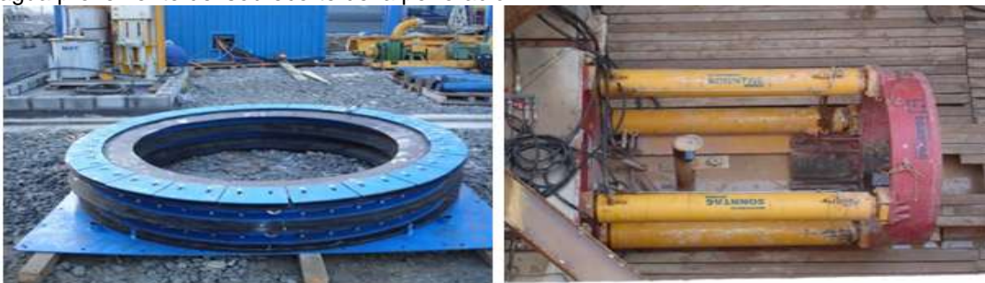
Chapón con juntas de estanqueidad Estación principal de empuje AVN2000D
