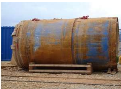
1 er módulo microtunneladora AVN2000D
