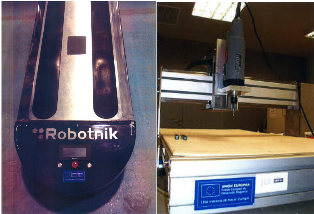
Prototipo del dispositivo de mecanizado de espumas automatizado y transportable
