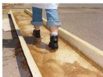
Ensayo de resistencia dinámica al agua
