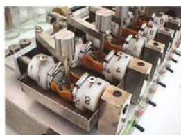
Penetrómetro Bally. Ensayo de resistencia al agua de materiales de empuje
