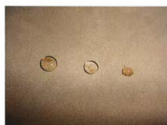
Ensayo de la solidez a la gota de agua
