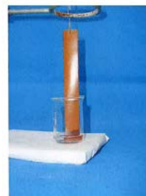
Ensayo de capilaridad para materiales de empuje y cordones
