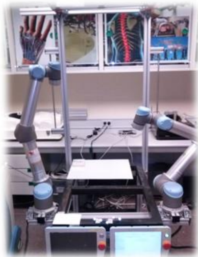
EQUIPO: Equipo robotizado de obtención de imágenes de retina mediante un escáner por láser confocal para la UMH_ Brazos robotizados CAMPUS: ELCHE_ Instituto de Bioingeniería
