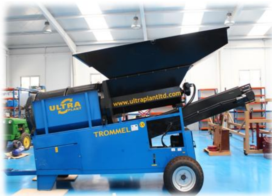
EQUIPO: Equipo para de afino para materiales fertilizantes orgánicos de alta capacidad de normalización granulométrica. CAMPUS: Orihuela
