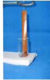
Ensayo de captaridad para materiales de empeine y cordones
