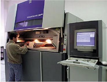
Equipo de sinterizado del ITA
