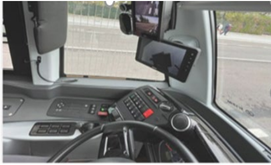
Pantallas de las cámaras que sustituyen a los retrovisores
