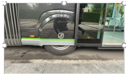
Carenado en el paso de rueda para mejorar la aerodinámica y la eficiencia energética
