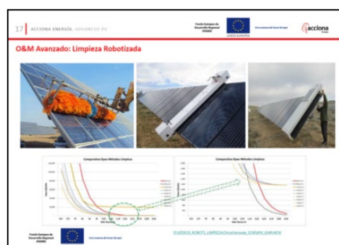
Desarrollo de limpieza robotizada en el proyecto de Acciona
