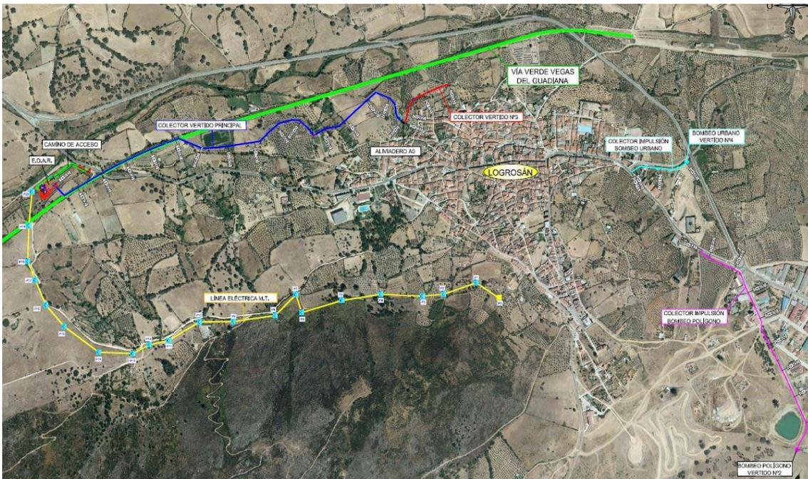
Para ello ha sido necesario la construcción de 1,8 km. de conducciones que transportan el agua residual por gravedad y 1,07 km mediante bombeo. La estación depuradora vierte sus aguas
