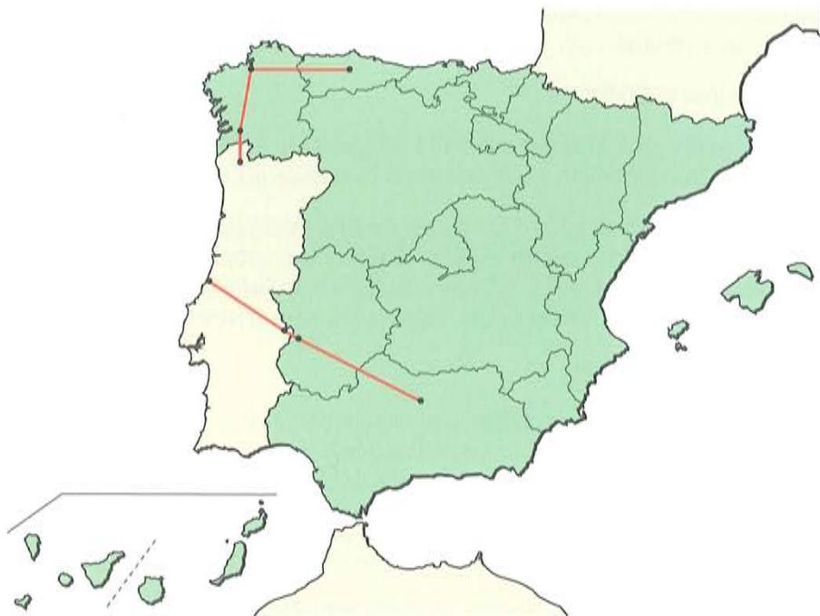
El gasoducto Córdoba-Badajoz-Frontera con Portugal servirá de entronque con la red portuguesa y permitirá el transporte de gas argelino con destino a Extremadura y Portugal, formando parte de la red Córdoba-Leiria, conexión primaria del sistema portugués con su fuente principal de aprovisionamiento. Dicho entronque enlazará con el gasoducto principal Setúbal-Braga en las inmediaciones de la ciudad portuguesa de Leiria.
