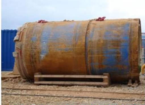
1er modulo microtuneladora AVN2000D
