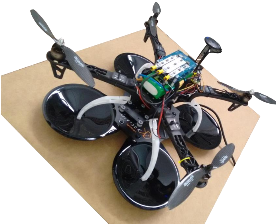
Figura 2. Base de carga con dron posado en ella
