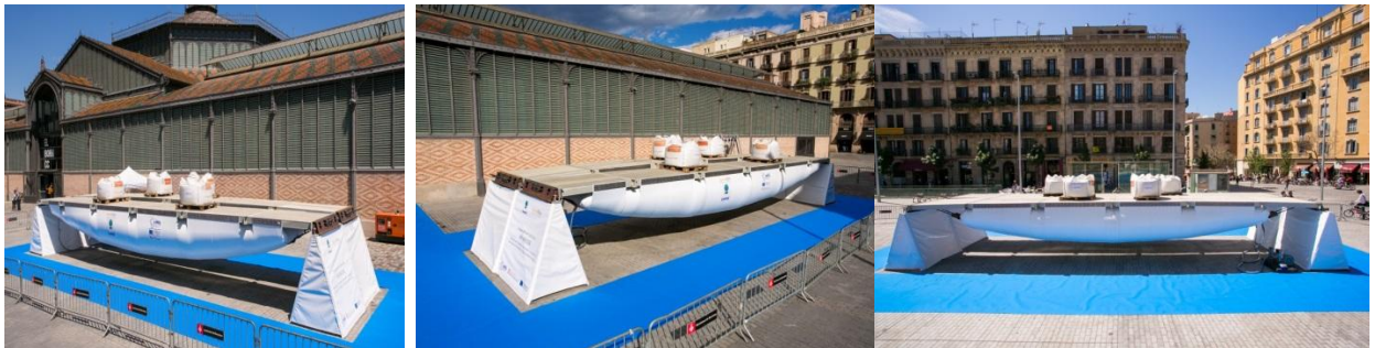
Ensayo del prototipo de puente Airbridge de 14m en el mercado del Born (Barcelona 28 Abril, 2014).
