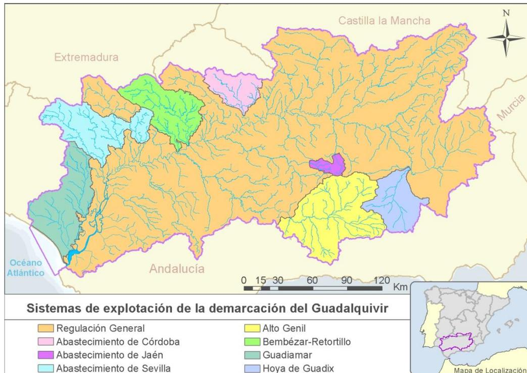
El concepto de Sistema de Regulación General consiste en que, a pesar de que el caudal de un embalse pueda estar dedicado únicamente a regadíos, el volumen que desde ese punto se suministre para ese uso, no tendrá que detrarse de otro embalse integrado en el sistema, que tenga un uso mixto y por tanto aumenta la disponibilidad para abastecimiento.
