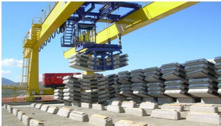
Anillos de dovelas prefabricadas
