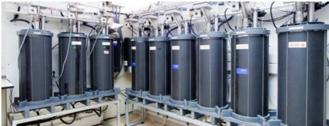
Unidad de biometanización de ainia UBIMET C36 compuesta por digestores de 36L para ensayos en semi-continuo con sistemas de monitorización de gases.
