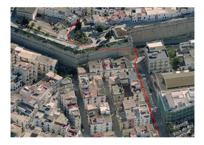
Esta actuación permite la conexión mediante conducciones para saneamiento y pluviales de la Plaça de Vila, ubicada en el núcleo amurallado de Dalt Vila, con el Paseo Vara de Rey, discurriendo para ello por el interior de un túnel que atraviesa la muralla.
