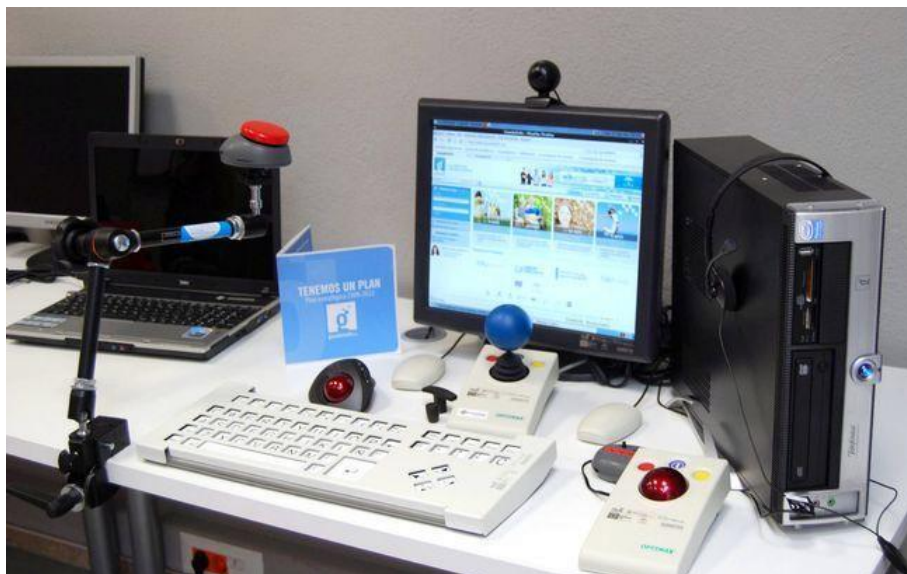
Ordenador equipado con los diferentes dispositivos de hardware y software adaptados a discapacitados
